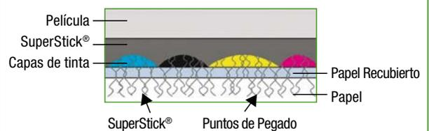
El adhesivo SuperStick® penetra mas allá de las capas de tinta y recubrimiento para crear un vínculo mecánico dentro de las fibras de papel.
